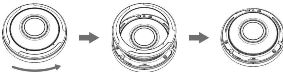
Шаг 1: Закрепите кронштейн на потолке или стене, где предполагается установка камеры. Затем закрепите винты. Подсоедините кабели, поверните камеру к кронштейну по часовой стрелке и затяните установочный винт;
